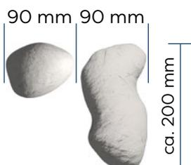
Wer Splitt und Kies bei Havelstein bestellt, sollte beachten, dass sich die Angabe der Korngröße immer auf die Siebmaschenweite der Produktionsanlage bezieht. Liegt zum Beispiel eine Korngröße von 60/90 Millimetern vor, ist ein Siebdurchgang (je nach Kornform) von bis zu 200 Millimetern möglich (siehe Abbildung). Aufgrund der unterschiedlichen Kornformen, wie plattig oder kubisch, sind optische Abweichungen erkennbar.
